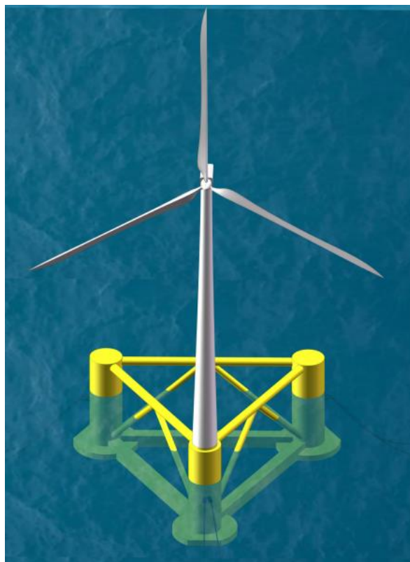
图 2.2.2-2 A 型浮体典型构型设计
