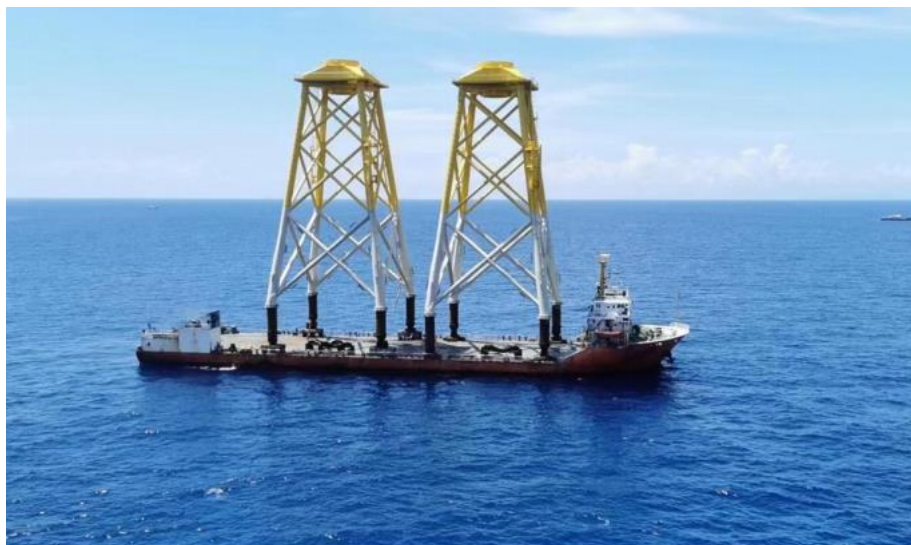
图 2.3.1-4 导管架运输示意图
