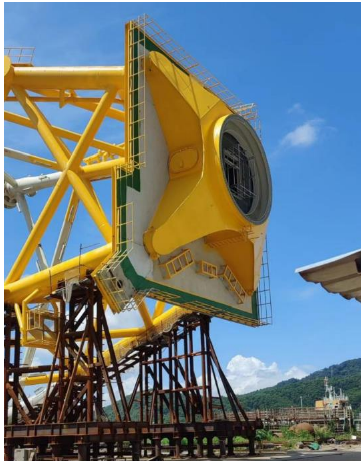
图 2.3.1-2 导管架过渡段加工示意图
